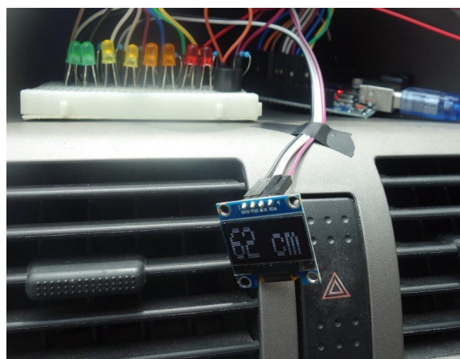
Obrázek 10- prototyp parkovacího asistenta sestaveného autorem práce [6]
