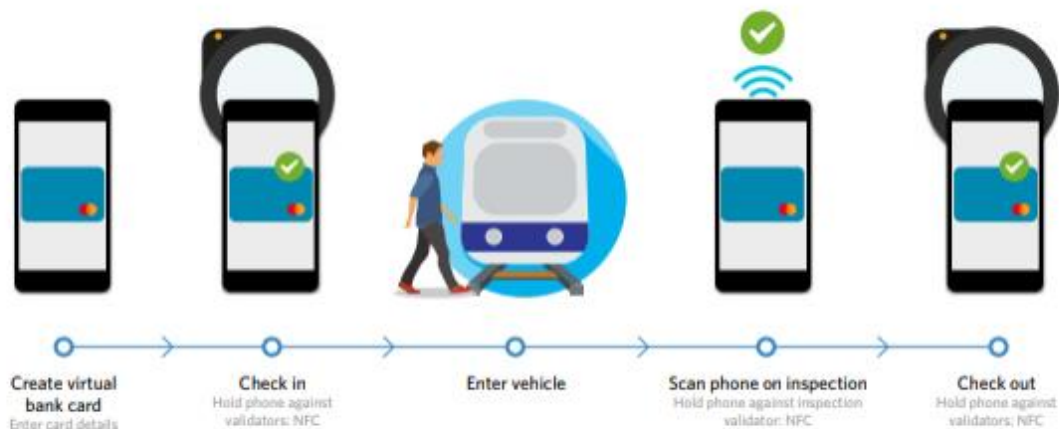
Obrázek 16 - Schéma odbavení cestujícího pomocí NFC technologie [27]
