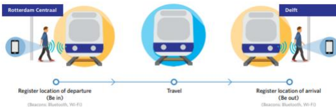
Obrázek 20 - Schéma fungování způsobu odbavení Be in – be out [27]
