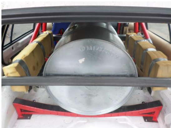
Obrázek 7 – Zatížení testovacího vozidla pohyblivým břemenem [4]
