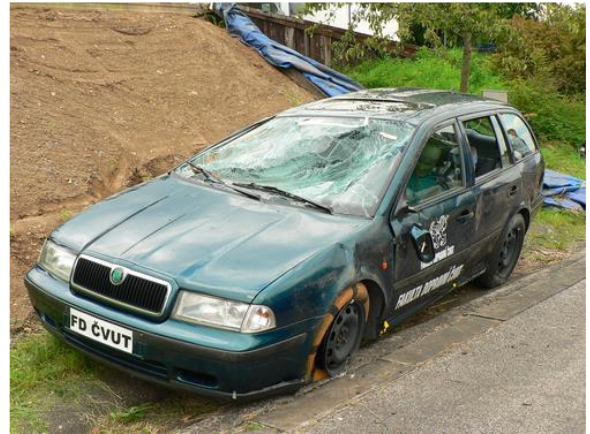
Obrázek 2 - vozidlo po simulaci přetočení [2]
