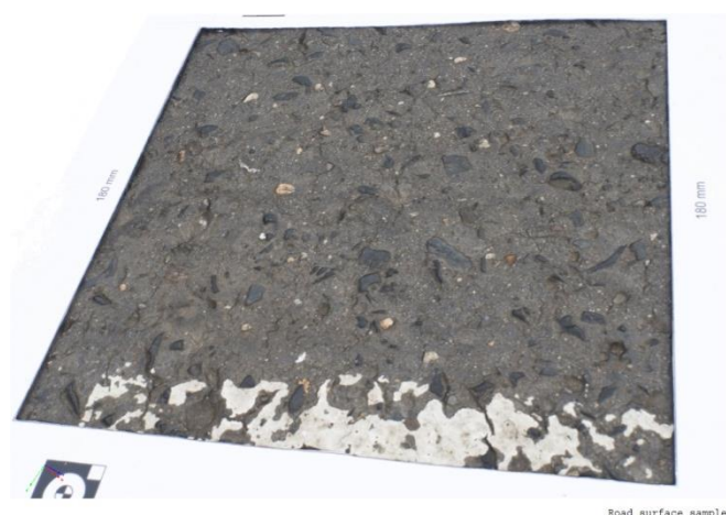
Obr. 3 Model povrchu vozovky
