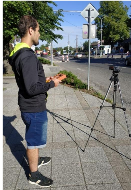
Obr. 41 - Realizácia prieskumu intenzity dopravy za pomoci TDC-Ultra
