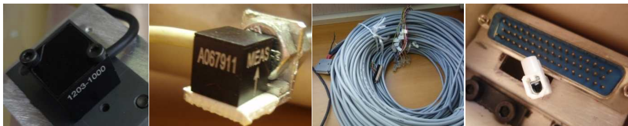
Obr. 5 - snímače zrychlení a kabeláž (zleva): tříosý akcelerometr 1203, jednoosý akcelerometr 1201, kabeláž s konektory RJ50, konektor DD50 v hrudníku figuríny.
