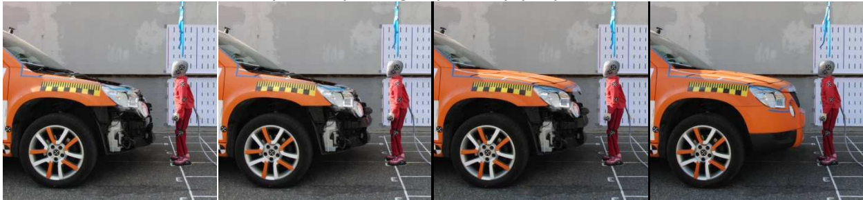
Obr. 2 – figurína P6 a automobil Škoda Yeti – porovnání střetové konfigurace při postupném nastrojení automobilu.
