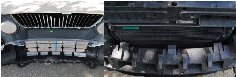
Obr. 23 – poškození automobilu po kolizi – test č. 201 – po odstrojení.
