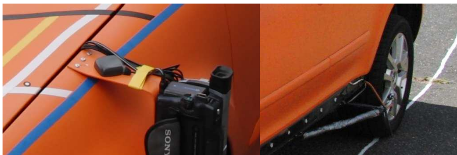
Obr. 9 – Umístění antény GPS snímače Xsens (vlevo), cyklo-tachometr (vpravo).
