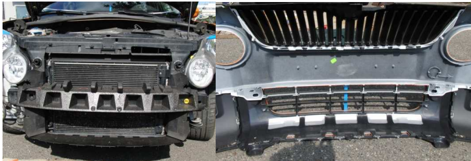
Obr. 29 – poškození automobilu po kolizi – test č. 301 – po odstrojení.
