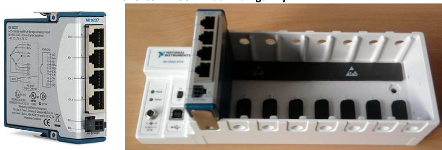
Obr. 6 – modul National-Instruments NI 9237 (vlevo) a ústředna NI 9172 (vpravo).
