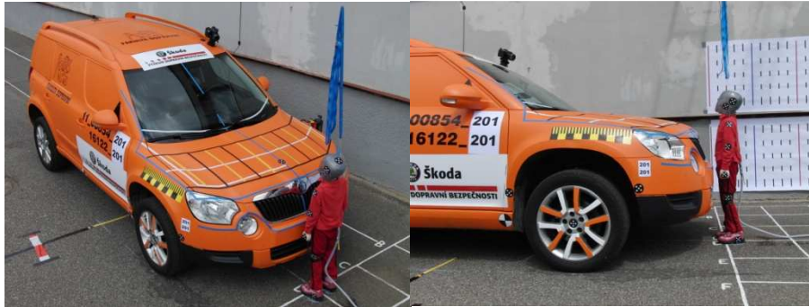
Obr. 1 – počáteční pozice figuríny čelem k přijíždějícímu vozidlu
