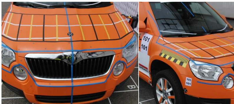
Obr. 8 - zóny na přední automobilu dle testovacího protokolu EuroNCAP pro testování impaktorem dětské hlavy (modře shora: referenční linie náběžné hrany kapoty, horní referenční linie nárazníku, vertikálně osa y, na obr. vpravo boční referenční linie; černě horizontálně: WAD 1 1000 a WAD 1500; bíle horizontálně: WAD 1250, černě a žlutě vertikálně: rozdělení vzniklých zón do dvanácti ekvivalentních testovacích polí), na obr. vpravo modře boční referenční linie.
