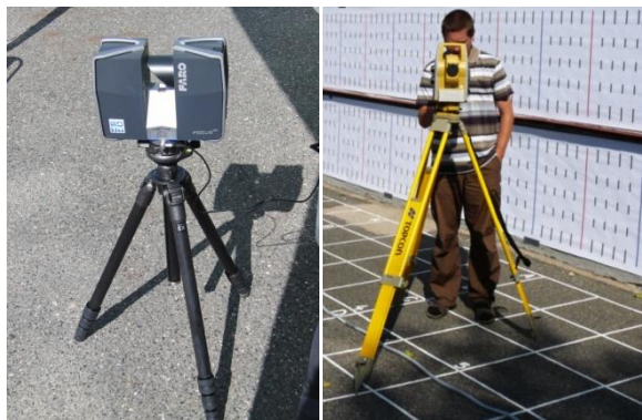
Obr. 12 – vlevo 3D scanner Faro Focus3D, vpravo totální stanice Topcon 3007i.
