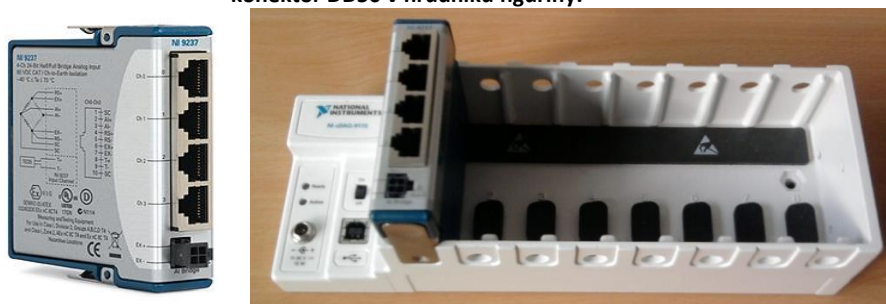
Obr. 5 – modul National-Instruments NI 9237 (vlevo) a ústředna NI 9172 (vpravo).
