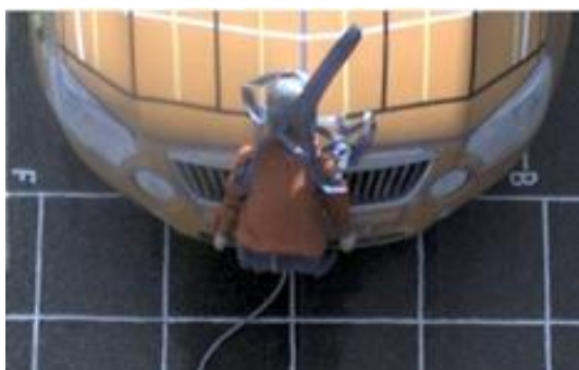
Obr. 20 – odchylka ve směru osy y – zkouška 203.
