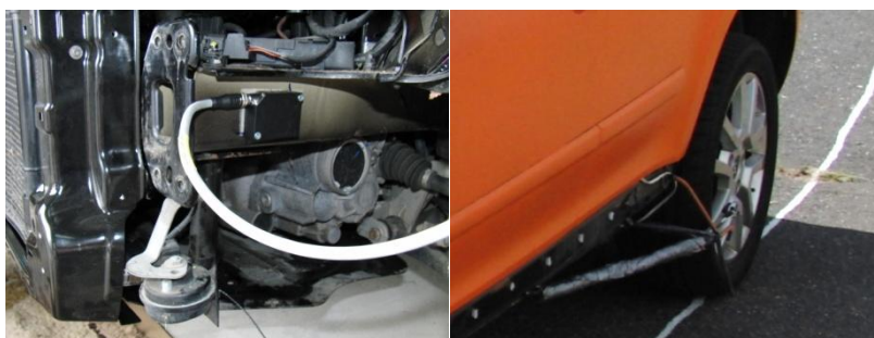
Obr. 10 – umístění optosnímače optoNCDT, cyklo-tachometr (vpravo).
