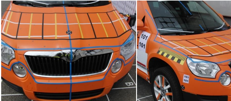
Obr. 7 - zóny na předí automobilu dle testovacího protokolu EuroNCAP pro testování impaktorem dětské hlavy (modře shora: referenční linie náběžné hrany kapoty, horní referenční linie nárazníku, vertikálně osa y, na obr. vpravo boční referenční linie; černě horizontálně: WAD 1 1000 a WAD1500; bíle horizontálně: WAD1250, černě a žlutě vertikálně: rozdělení vzniklých zón do dvanácti ekvivalentních testovacích polí), na obr. vpravo modře boční referenční linie.
