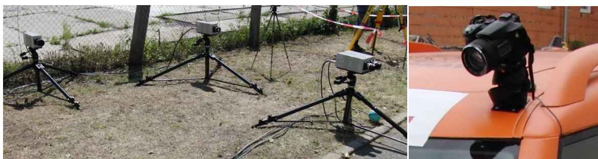
Obr. 11 – vysokorychlostní kamery Redlake (vlevo), fotoaparát Casio, záběr ze střechy automobilu (vpravo).
