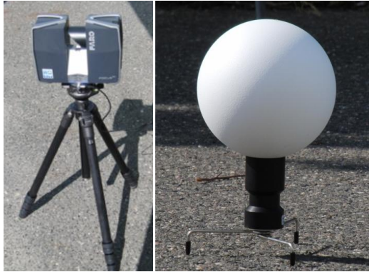
Obr. 59 – Skener FARO Focus3D a jeden z kulových referenčních objektů.
