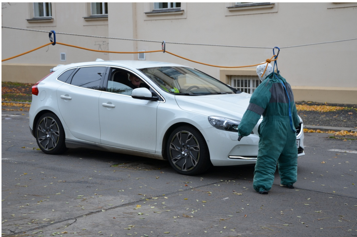
Obr. 8 – jdoucí figurína, místo středu PP roh, auto detekuje a nebrzdí
