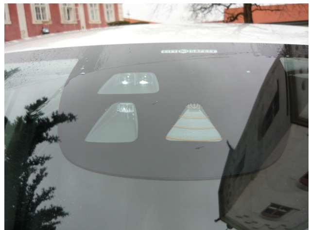
Obr. 4 Kamera, vysílač a přijímač laseru
