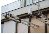
Vysokorychlostní kamera Kodak Ektapro HG 2000, snímání až 2 000 snímků/s
