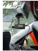
Měření rychlosti a zrychlení vozidla, přístroj Etanu 2.0
