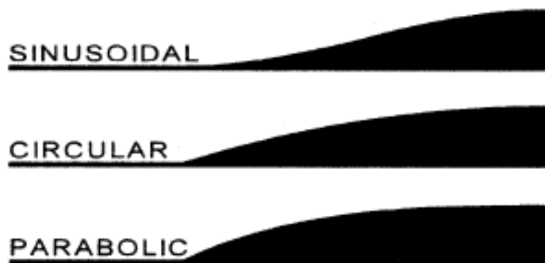
Obr. 2: Detail profilu rampy sinusového, kruhového a parabolického tvaru.
