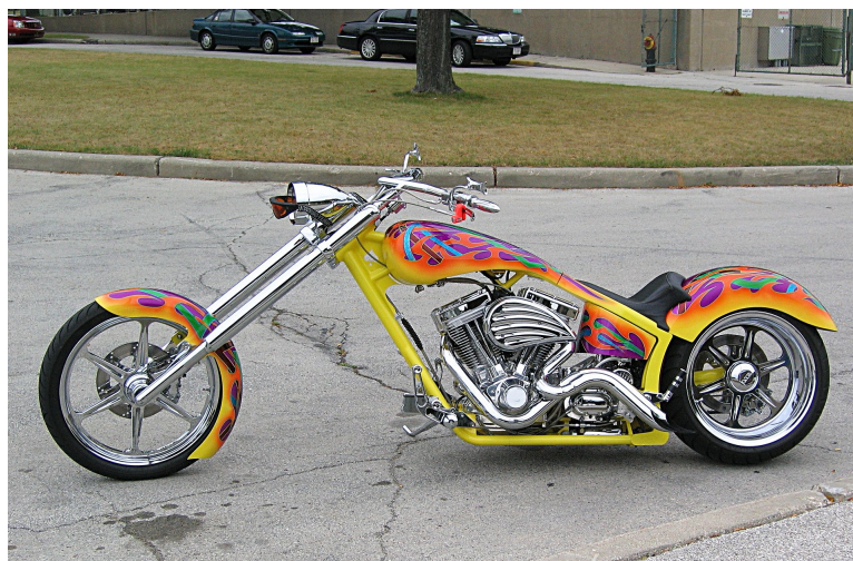
OBRÁZEK 5.4: Zjevný záklon rejdové osy u motocyklu [26]
