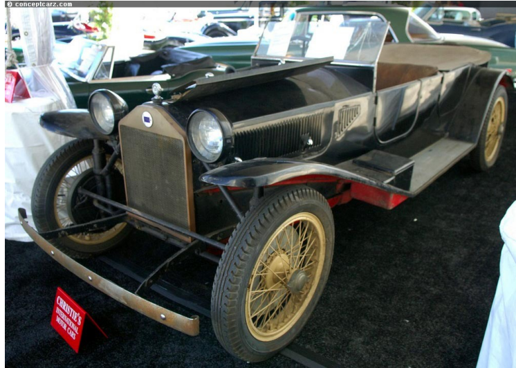
OBRÁZEK 3.1: Nezávislé zavěšení předních kol automobilu Lancia Lambda [16]
