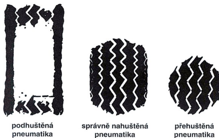
OBRÁZEK 6.1: Porovnání správného a špatného nahuštění pneumatik [31]
