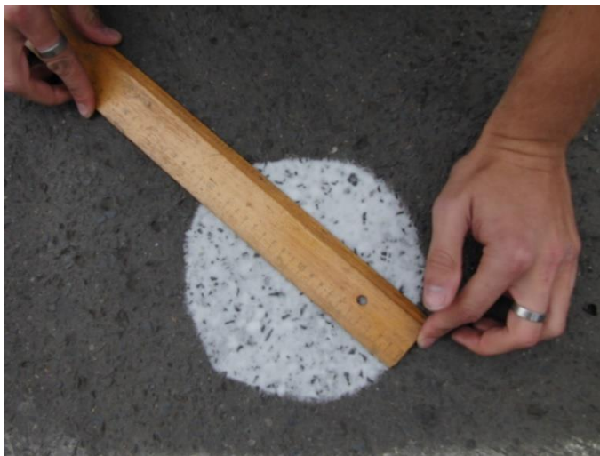
Obr. 19 – Měření průměru rozprostřené plochy
