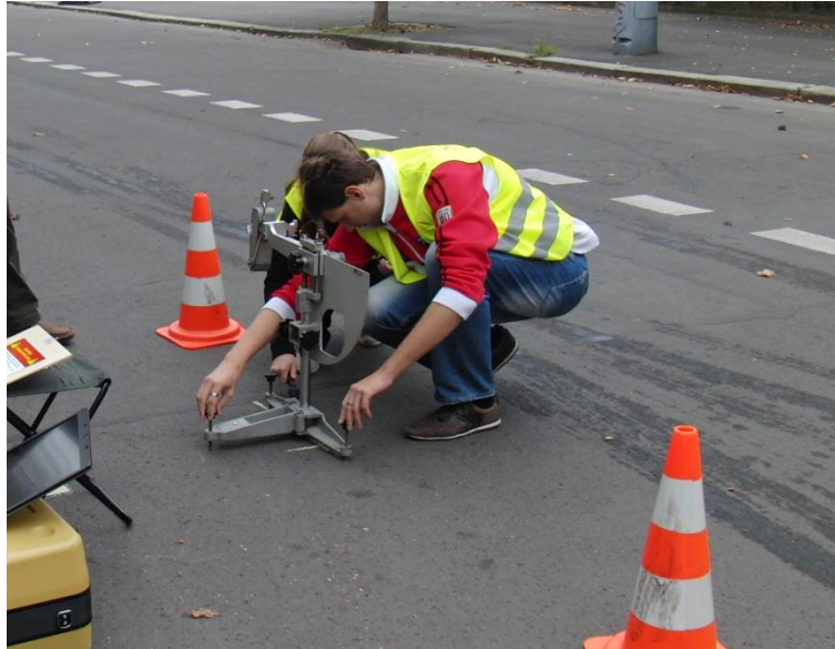
Obr. 20 – Nastavení kyvadla do vodorovné polohy
