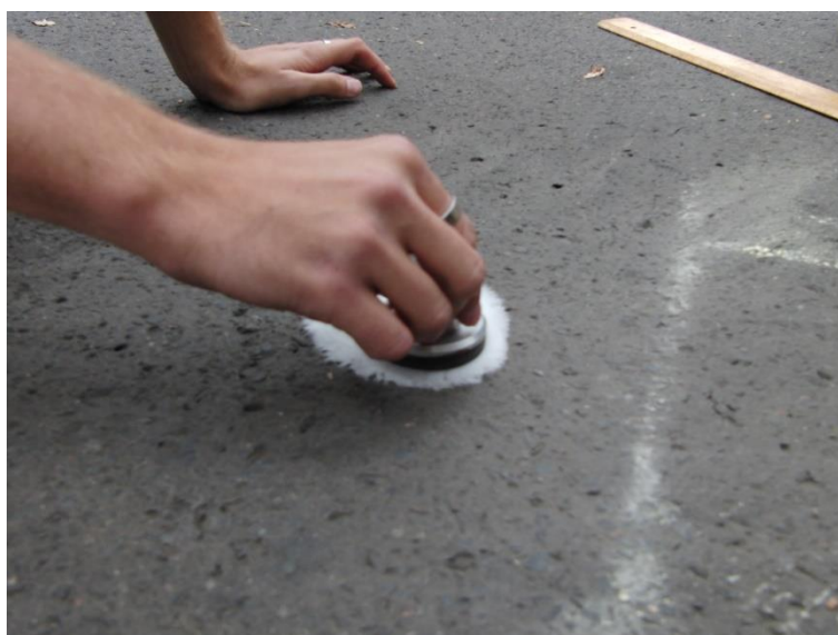
Obr. 18 – Rozprostírání skleněných kuliček stěrkou
