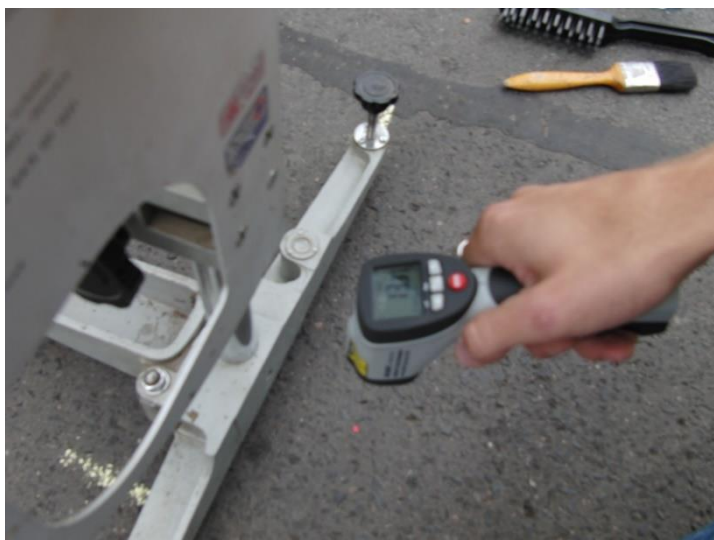
Obr. 22 – Měření teploty povrchu před provedením zkoušky
