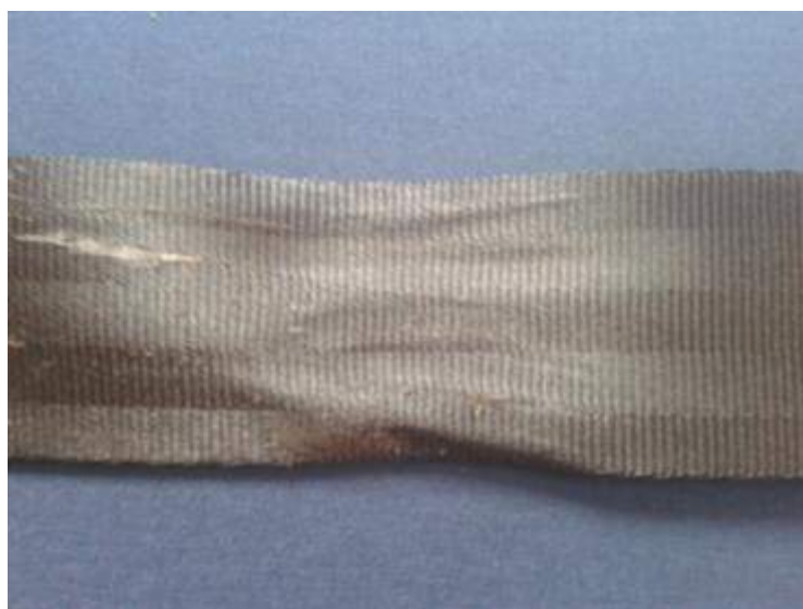
Obrázek 18 - znatelně "zmuchlaná" část popruhu bezpečnostního pásu
