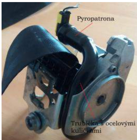
Obrázek 32 - navíječ bezpečnostního pásu s pyrotechnickým přepínacím zařízením
