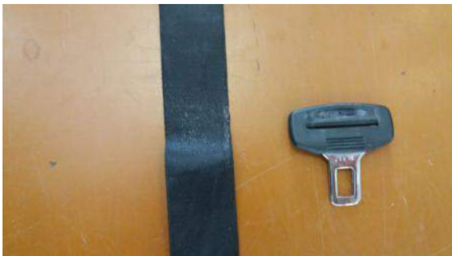
Obrázek 15 - natavení popruhu bezpečnostního pásu v oblasti průvlečného oka zámku
