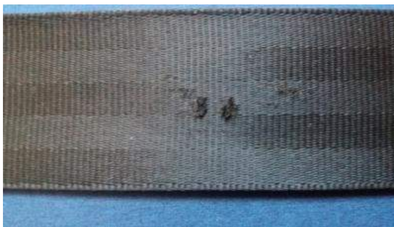
Obrázek 13 - poškození tkaniny bezpečnostního pásu
