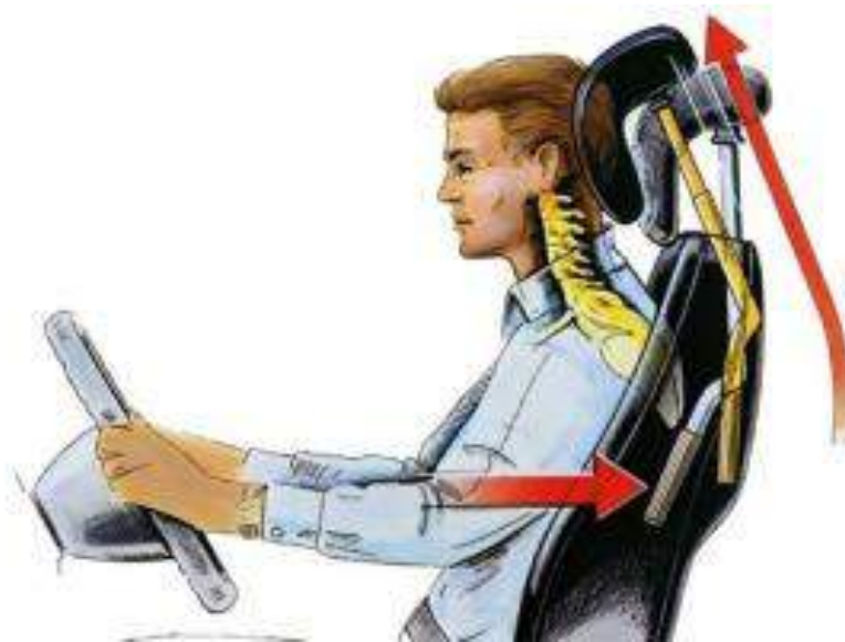
Obrázek 4 - aktivní opěrka hlavy [13]
