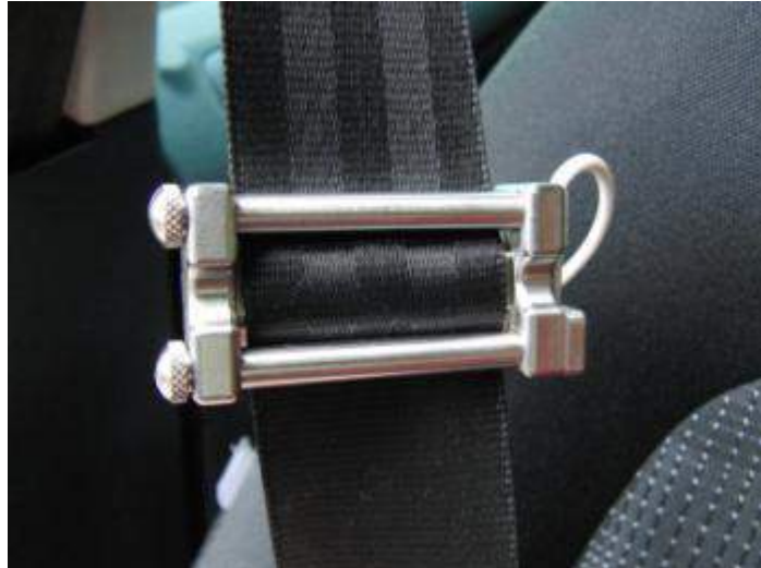
Obrázek 36 - detail spony pro měření síly v bezpečnostním pásu
