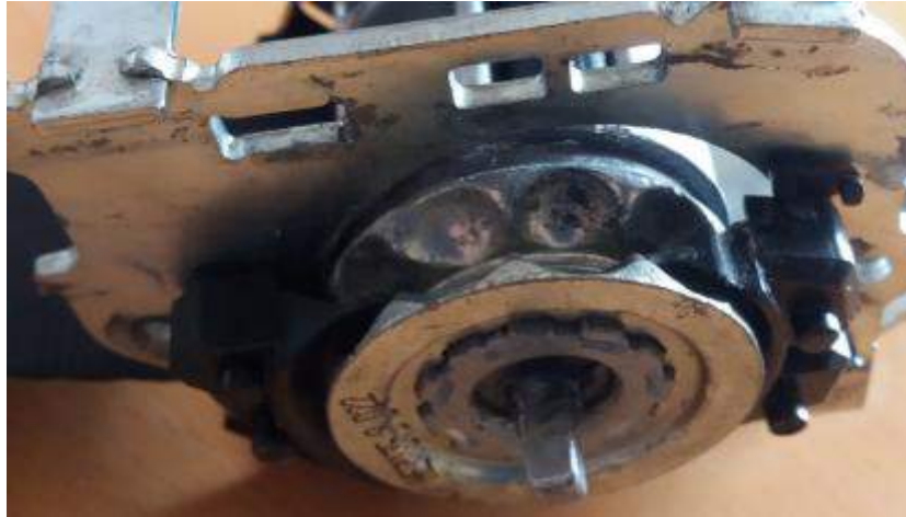
Obrázek 33 - ozubení navíječe bezpečnostního pásu pro ocelové kuličky
