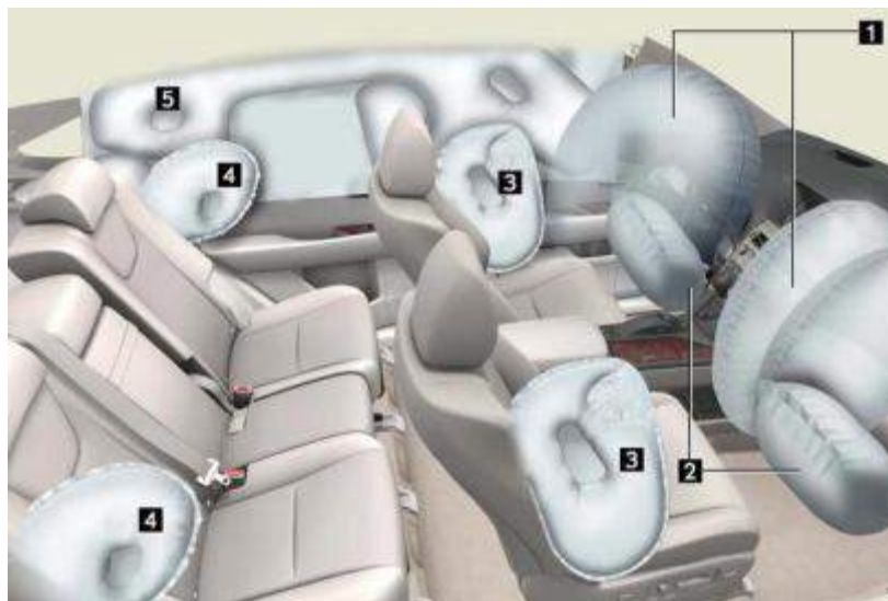
Obrázek 7 - umístění a typy airbagů v automobilu [10]
