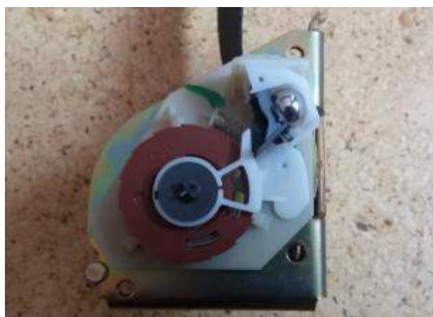
Obrázek 23 - kyvadlový mechanismus, kde je jako závaží použita ocelová kulička
