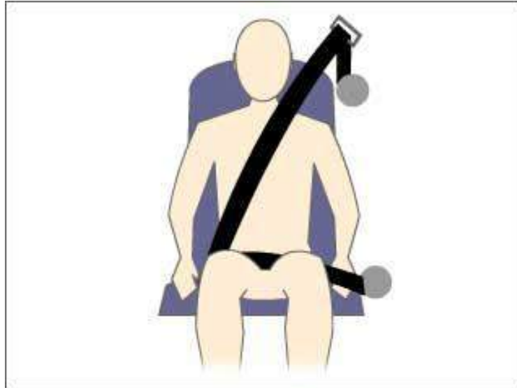
Obrázek 1 - třibodový bezpečnostní pás [27]
