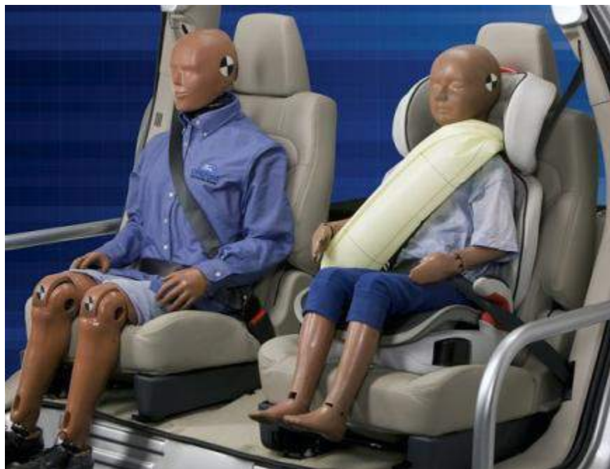
Obrázek 2 - bezpečnostní pás s implementovaným airbagem [30]
