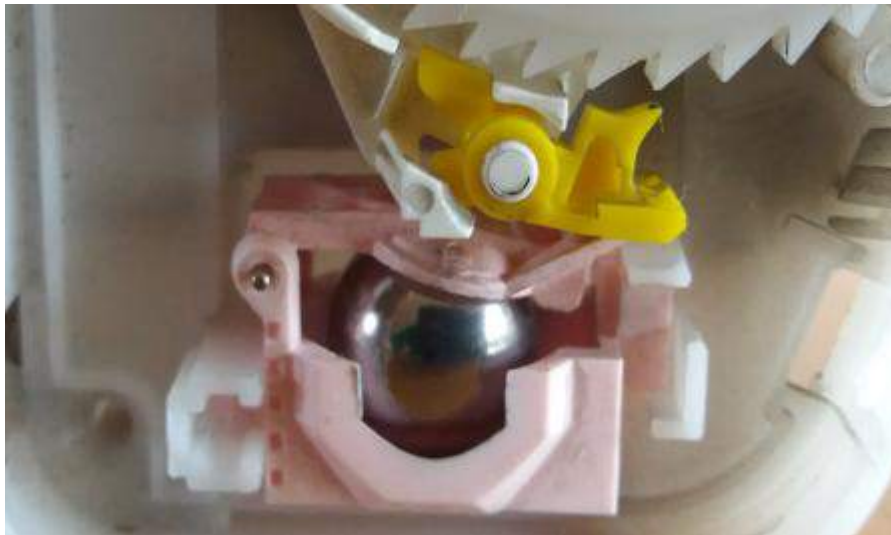
Obrázek 24 – detail mechanismu blokování navíječe ve "volné" poloze
