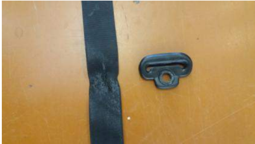
Obrázek 16 - natavení popruhu bezpečnostního pásu v oblasti horního průvlečného oka
