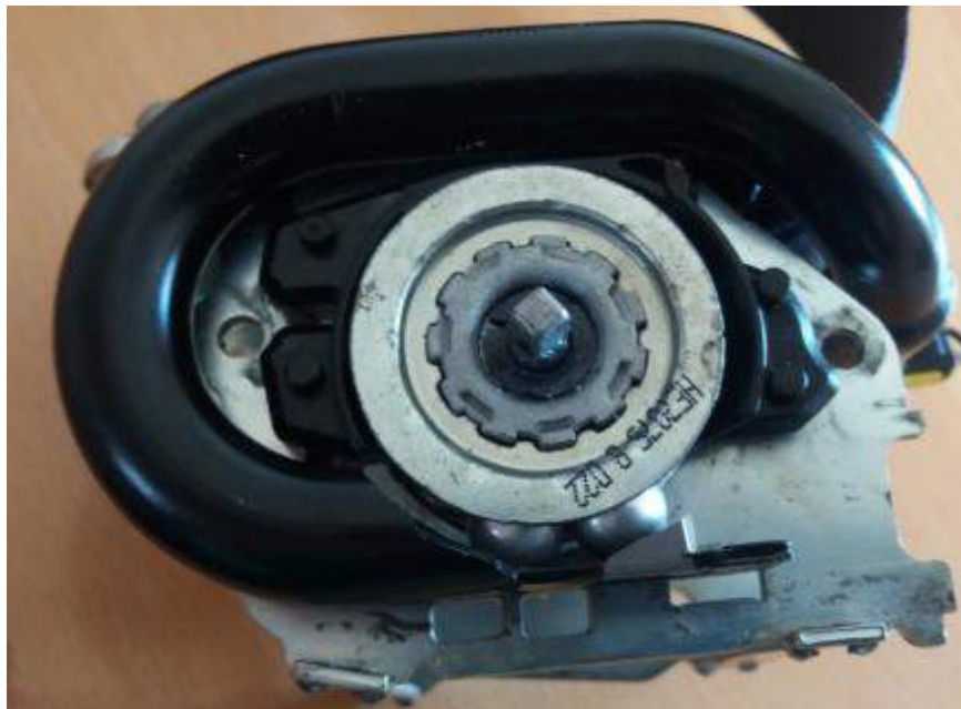
Obrázek 34 - ocelové kuličky v ozubení navíječe
