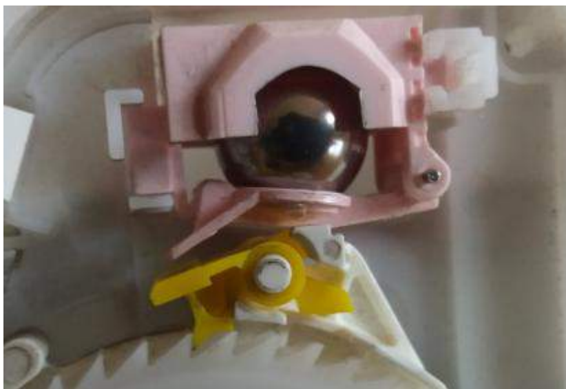
Obrázek 25 – detail mechanismu blokování navijče v "blokovací" poloze
