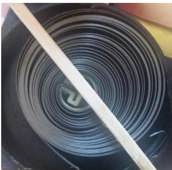
Obrázek 21 - pružina navíjecího mechanismu
