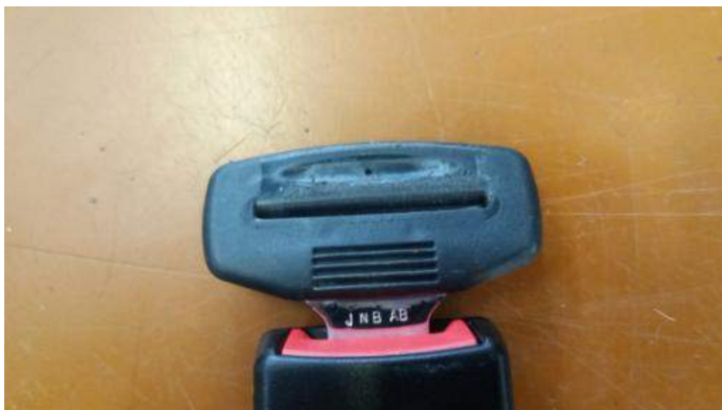
Obrázek 19 - stopy na průvlečném oku zámku
