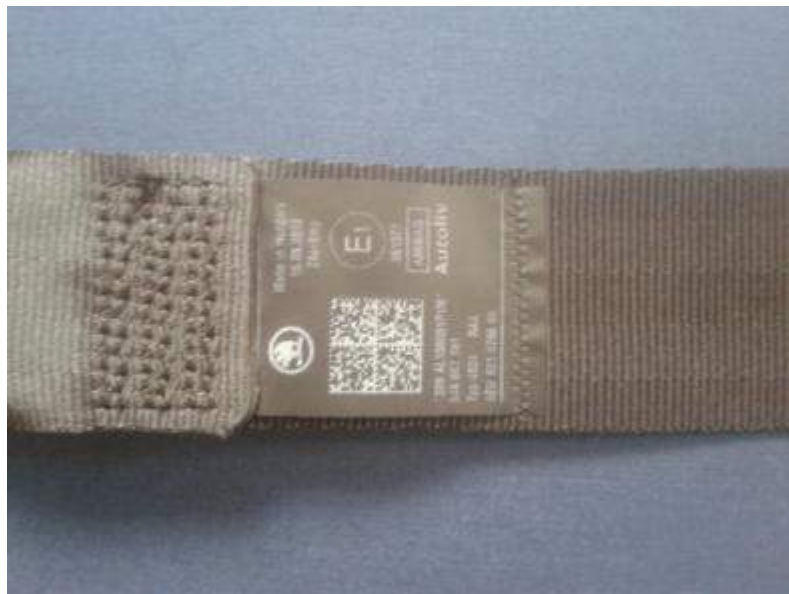
Obrázek 8 - příklad evropské homologační značky na bezpečnostním pásu
