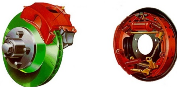
OBRÁZEK 2.1: Brzdy: kotoučová (vlevo), bubnová (vpravo)
