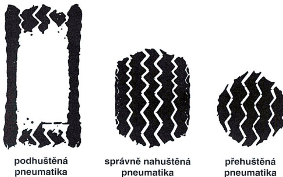
OBRÁZEK 5.1: Porovnání správného a špatného nahuštění pneumatik [23]
