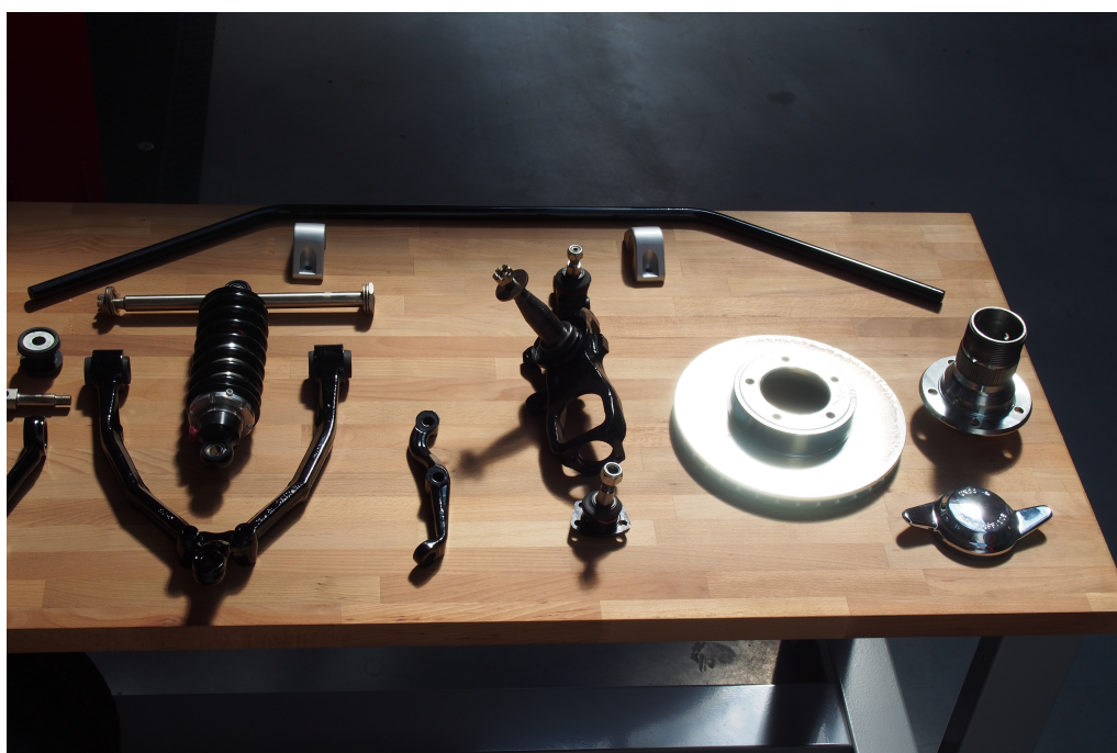
OBRÁZEK D.4: Díly přední nápravy, uprostřed umístěna těhlice, nahoře stabilizátor
