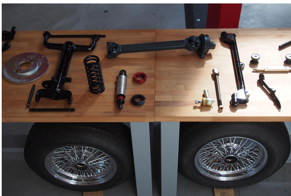
OBRÁZEK D.2: Vlevo díly zadní nápravy, ve středu kardan a vpravo jezdec řízení
