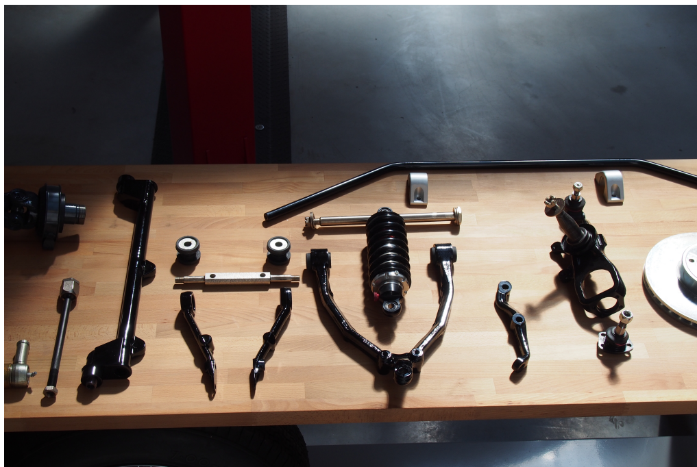
OBRÁZEK D.3: Díly přední nápravy, uprostřed umístěny trojúhelníková ramena
