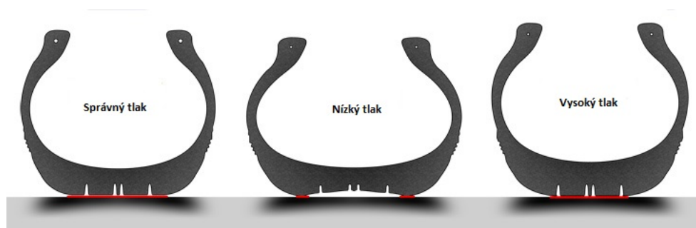
OBRÁZEK 2.2: Porovnání správného a špatného nahuštění pneumatik [3]
