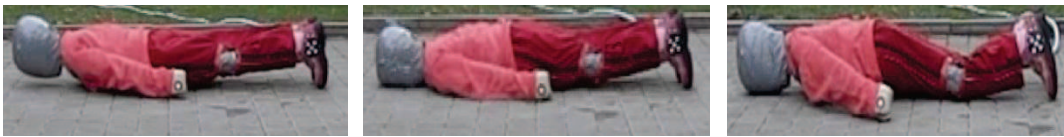
Obrázek 12 Sekvence pádu na zámkovou dlažbu
