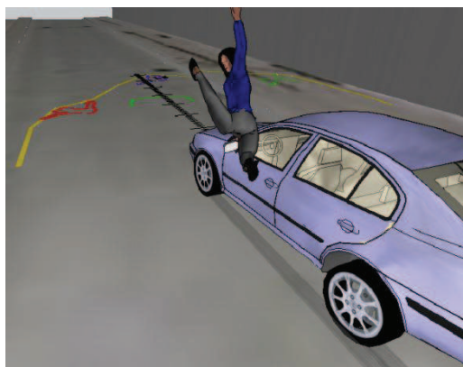
Obrázek 34 Ukázka ze simulace nárazu na levý roh vozidla při 50 km.h -1
