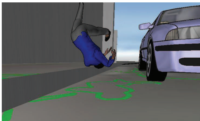
Obrázek 31 Dopad chodce na hranu obrubníku při 40 km.h -1
