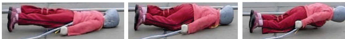
Obrázek 14 Sekvence pádu na BKV panel
