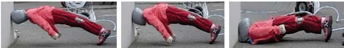
Obrázek 18 Sekvence pádu na city blok
