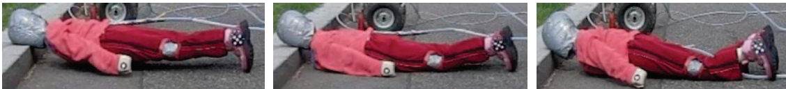
Obrázek 17 Sekvence pádu na hranu obrubníku
