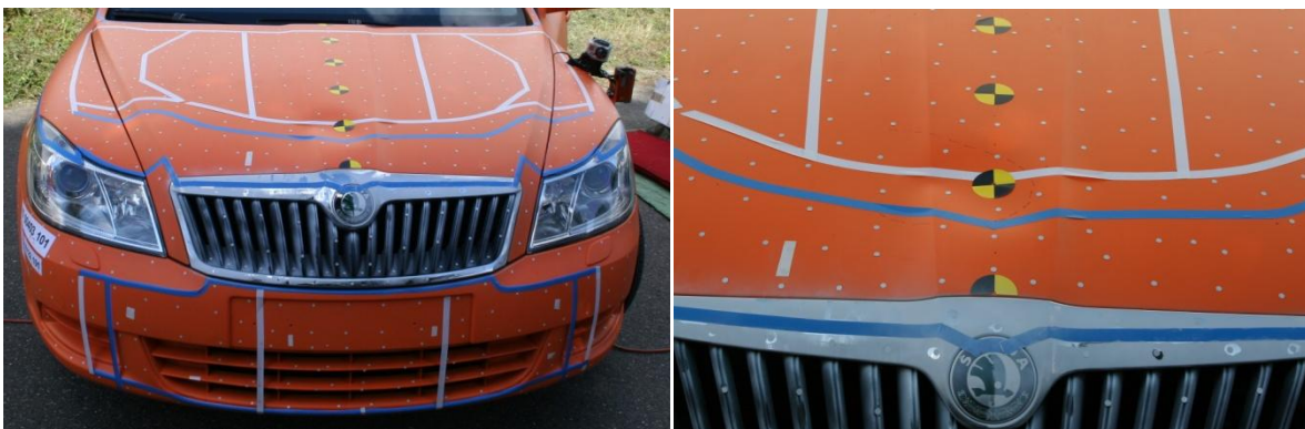
Obr. 18 – Poškození automobilu po kolizi – test č. 101.
