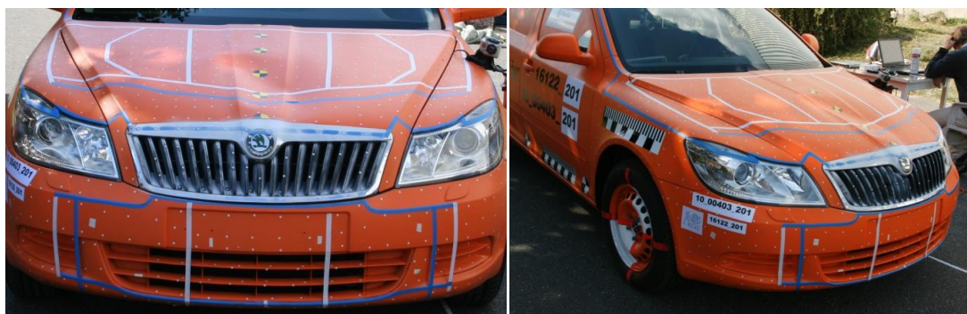
Obr. 23 – Poškození automobilu po kolizi – test č. 201.
