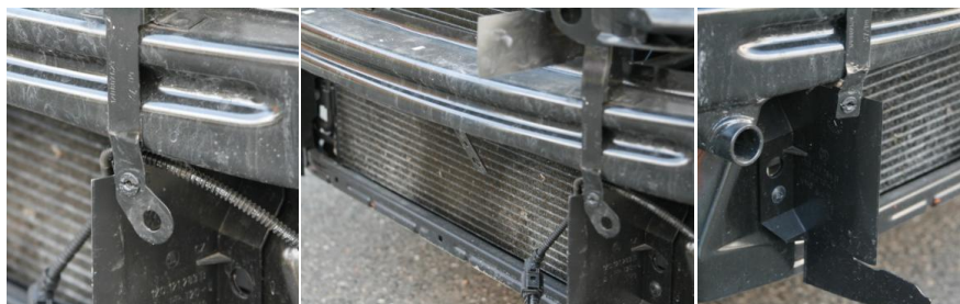
Obr. 24 – Poškození automobilu po kolizi – test č. 201 – po odstrojení.
