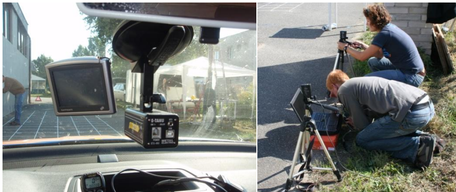
Obr. 8 – Přístroj Etanu 2.0 (vlevo), optická závora (vpravo).
