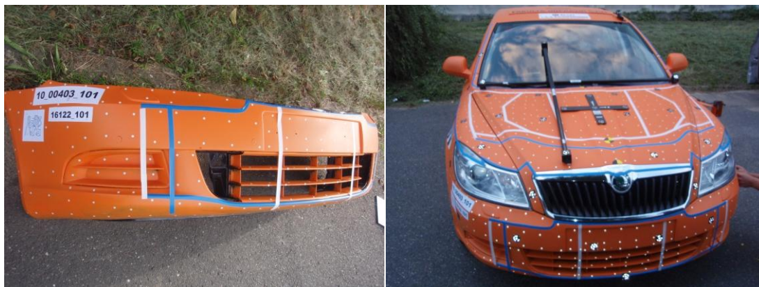
Obr. 52 – Vlevo: plastový nárazník s reflexními pozičními značkami, vpravo: automobil se sítí pozičních reflexních značek a s magnetickými kódovanými fotogrammetrickými terčíky. Dále jsou použity kódované výtyčky a souřadnicový poziční kříž.
