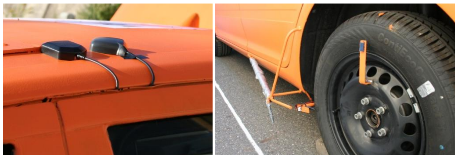
Obr. 10 – Umístění antén GPS (vlevo), cyklo-tachometr (vpravo).
