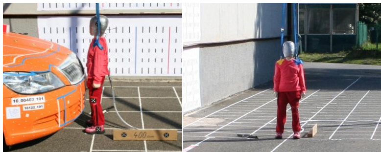
Obr. 1 - Pozice figuríny vzhledem ke kolidujícímu vozidlu.
