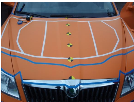
Obr. 7 - Zóny na přední automobilu dle předpisu 2003/102/ES (modře referenční linie náběžné hrany kapoty a její offset 165 mm, bíle WAD 1000 a prostor vzniklý odstupem od boční vztážené čáry resp. referenční linie náběžné hrany kapoty)
