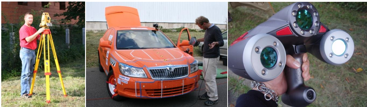
Obr. 13 – Totální stanice Topcon 3007i (vlevo), 3D Handy-scanner (uprostřed a vpravo).
