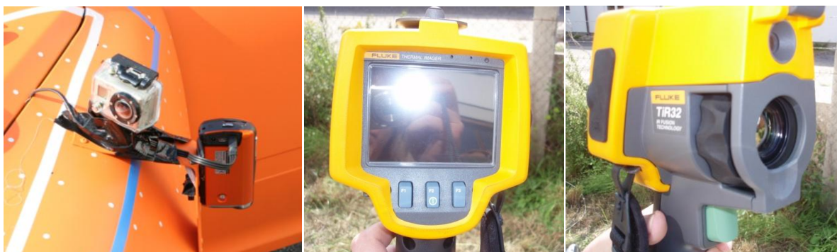
Obr. 12 – Minikamera GoPro a kamera Panasonic SDR 20 pro navádění do místa střetu (vlevo), termokamera Fluke (uprostřed a vpravo).
