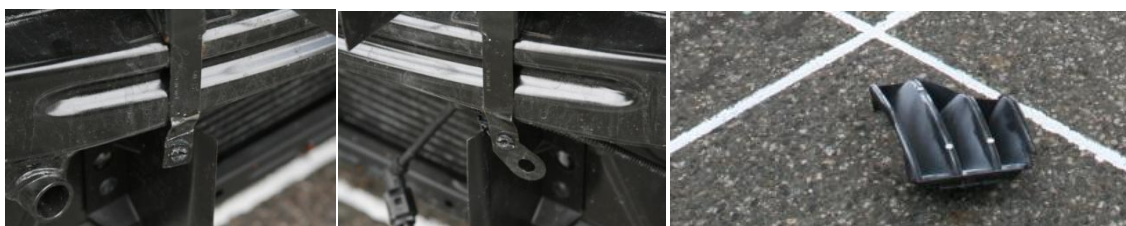
Obr. 30 – Poškození automobilu po kolizi – test č. 301 – po odstojení, vpravo odlétnuvší úlomek mřížky chladiče.
