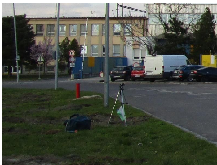
Obr. 61: Stabilizácia statívu zaťažením. zdroj: autor
