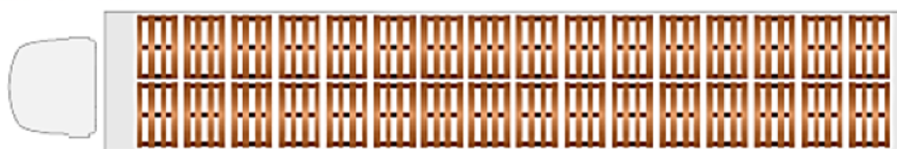
Obrázek 3.4 Schéma umístění 32 palet do návěsu SCHMITZ CARGOBULL SCS 24 / L-13,62 BS
