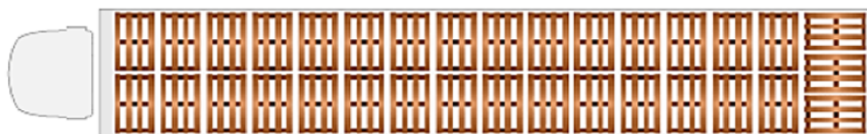
Obrázek 3.5 Schéma umístění 33 palet do návěsu SCHMITZ CARGOBULL SCS 24 / L-13,62 BS
