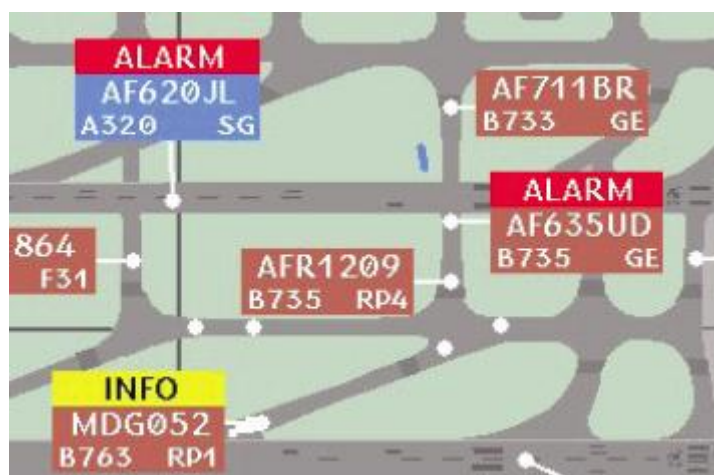
Obrázek 4-8: Zobrazení alarmů NOVA 9000 RIMCAS
