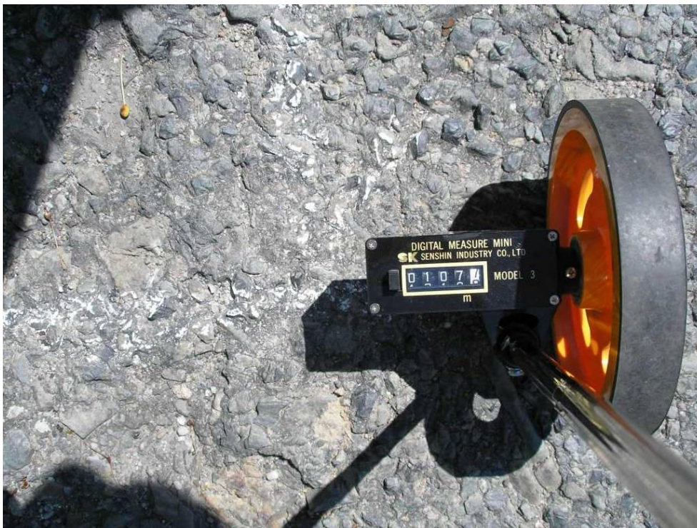
obr. 5 Délkoměrné kolečko se skládací (teleskopickou) rukojetí
