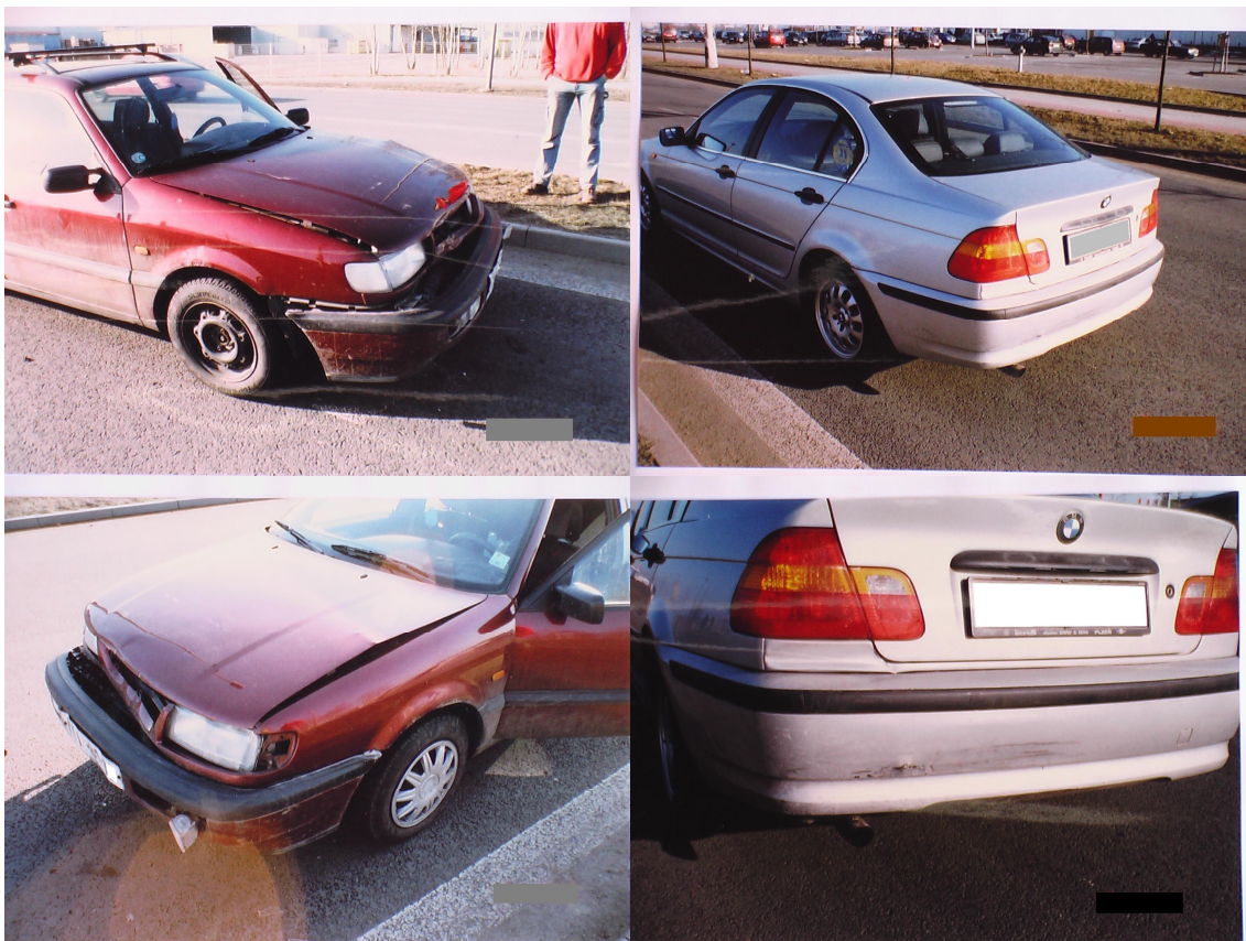
obr. 13 Různá tuhost v kolizní zóně střetnuvších se vozidel-příklad 2
