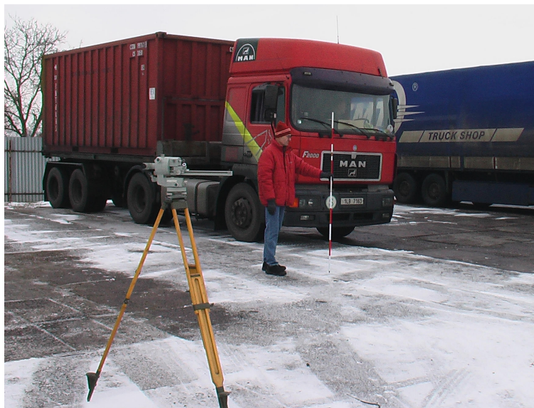
obr. 60 Zjišťování poloh hranic mrtvého prostoru
