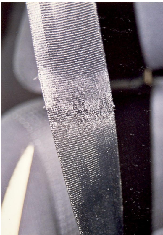
obr. 44 Prosmýknutím pásu po oblině spony při působení velké přitlačné síly se vyvíjí teplo postačující k natavení tkaniny, jejíž některá vlákna mohou být i potrhána 13
