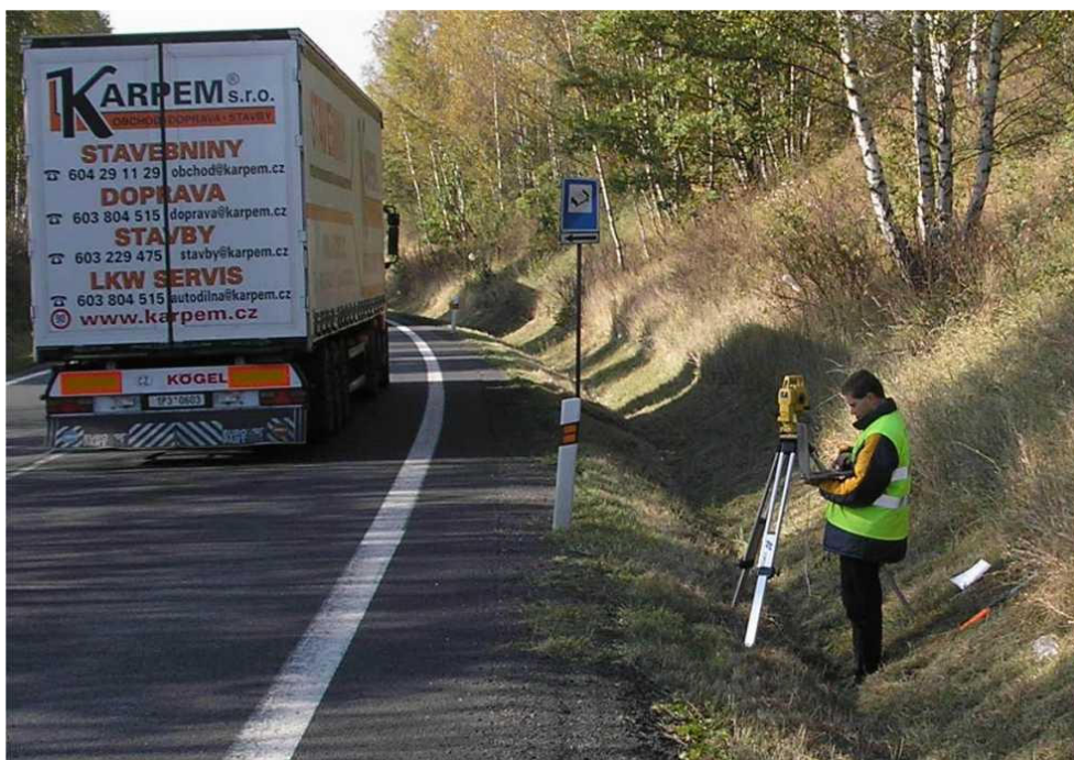
obr. 8 Data z Total-Station lze přenášet přímo do notebooku na měřeném místě
