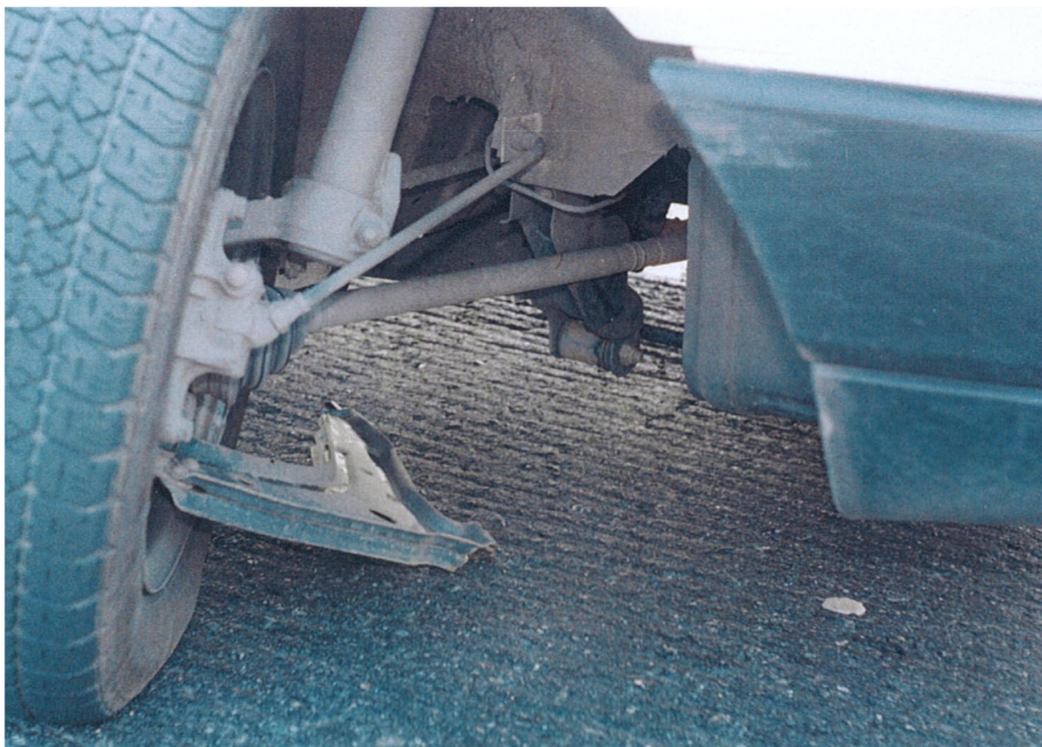
obr. 51 Vyvrácené pravé kolo táhne spojovací tyč řízení vpravo a tím stáčí levé kolo doleva 14
