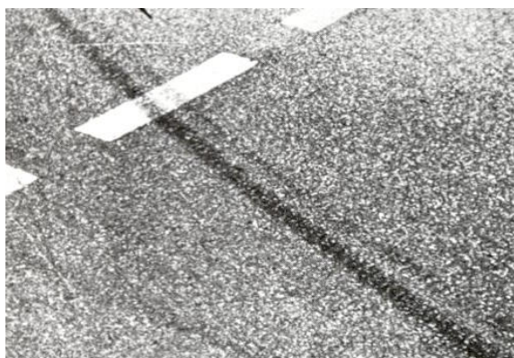
obr. 24 a, b Driftové stopy vznikající při mezní boční (odstředivé) síle, tedy výhradně při jízdě po oblouku.
