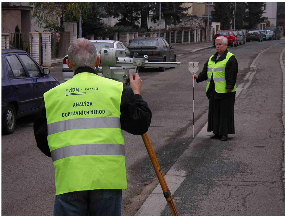
obr. 6 Autoredukční tachymetrický přístroj ZEISS BRT 006
