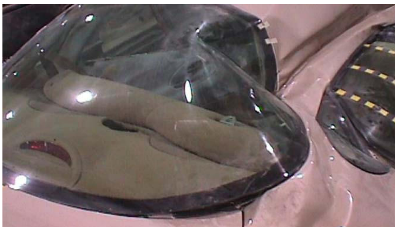
obr. 21 Zasklení karoserie polykarbonáty
