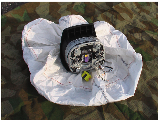
obr. 45 Plyn je z airbagu odváděn pórní tkaninou na straně odvrácené od těla osoby
