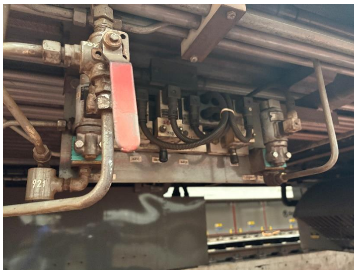
Fotografie 1: Tlakové body pro připojení snímačů 25
